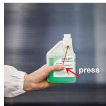
Füllen des Kalibrierbehälters durch drücken auf die Flasche. / Fill calibration compartment with simple press
