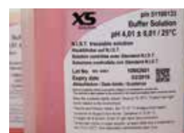
Chargennummer, Istwert und Ablaufdatum sind auf der Flasche vermerkt / Lot number, Actual Value and expiration date reported on the bottle
